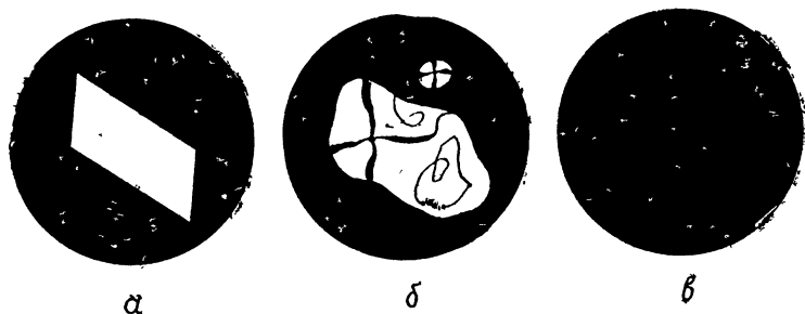
Рис. 1. Между скрещенными поляроидами кристалл выглядит ярко светящимся (а), жидкий кристалл также анизотропен и также виден между скрещенными поляроидами (б), изотропный расплав не виден в этих условиях (в)
